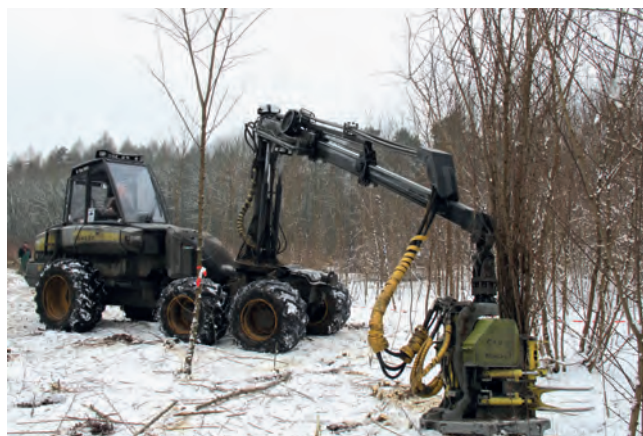
Abb. 16: Fäller-Bündler-System BRACKE bei der flächigen Ernte der Zwischenfelder auf Parzelle 4
