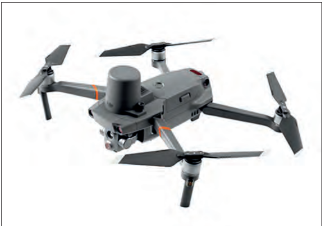
Abb. 6: kleine DJI Mavic enterprise advanced Drohne mit leistungsfähigen Wärmebildsensor und ½ Zoll RGB Kamera sowie RTK-Stabilisierungstool
