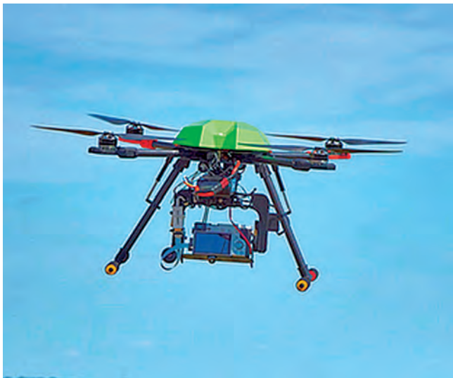
Abb. 1: Der GreenCopter der Firma IBR Ruppe mit RGB Kamera
