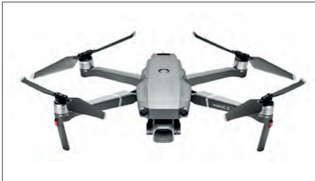
Abb. 5: kleine, leistungsfähige DJI Mavic 2 pro mit 1 Zoll RGB Kamera der Traditionsfirma Hasselblad (Produktion 2022 eingestellt)
